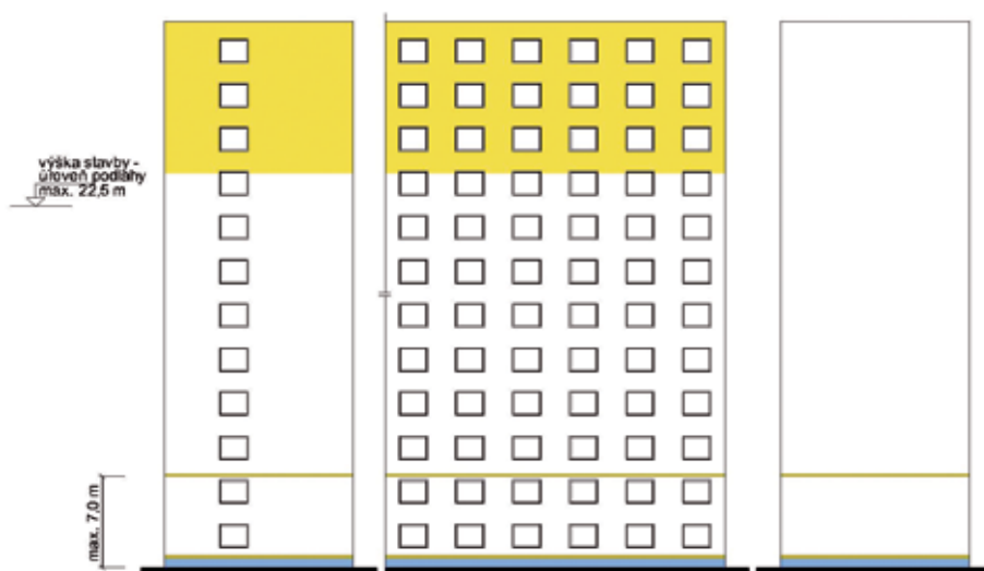
Obr. 8 Samostatne stojaca budova s výškou stavby viac ako 22,5 m a s tepelnou izoláciou z EPS s hrúbkou najviac 100 mm
