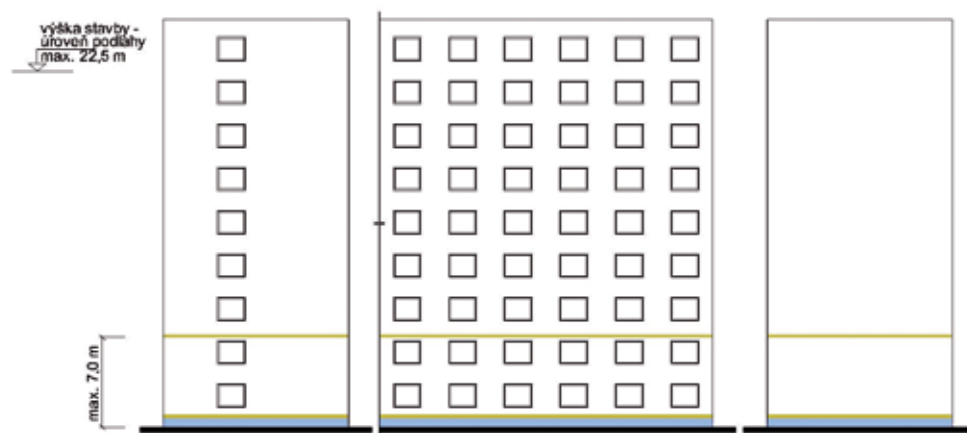
Obr. 6 Samostatne stojaca budova s výškou stavby najviac 22,5 m a s tepelnou izoláciou z EPS s hrúbkou najviac 100 mm
