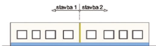
Susediace budovy so spoločnou deliacou stenou
