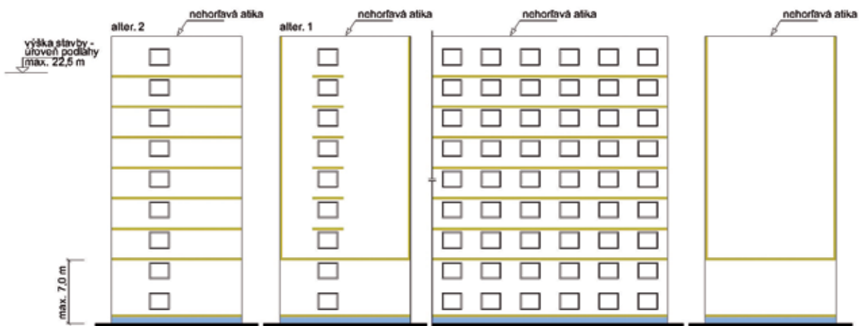
Obr. 7 Samostatne stojaca budova s výškou stavby najviac 22,5 m a s tepelnou izoláciou z EPS s hrúbkou viac ako 100 mm
