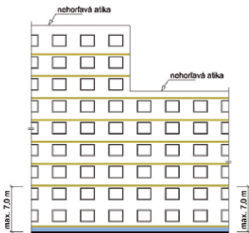
Obr. 20 Umiestnenie požiarnych zábran na budovách s časťami rôznej výšky a úrovne okien
