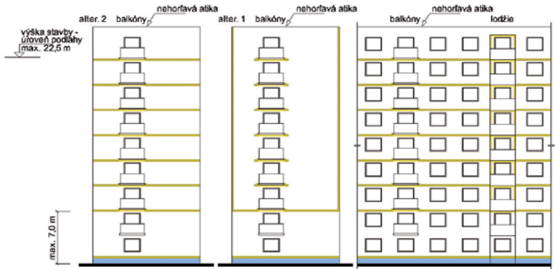
Obr. 15 Rôzne druhy ETICS v oblasti vystupujúcich a ustupujúcich stavebných konštrukcií budov s výškou stavby najviac 22,5 m s hrúbkou EPS viac ako 100 mm
