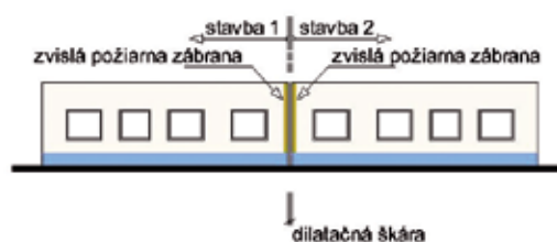
Obr. 19 Zvislé požiarne zábrany pri použití ETICS s triedou reakcie na oheň B-s2, d0
