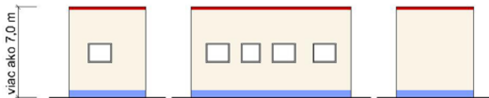
Obr. 4 Návrh požiarnej zábrany samostatne stojacej jednopodlažnej budovy s plochou strechou
