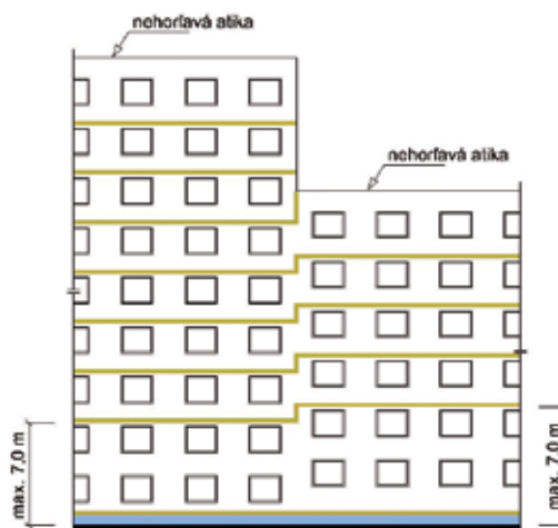
Obr. 20 Umiestnenie požiarnych zábran na budovách s časťami rôznej výšky a úrovne okien
